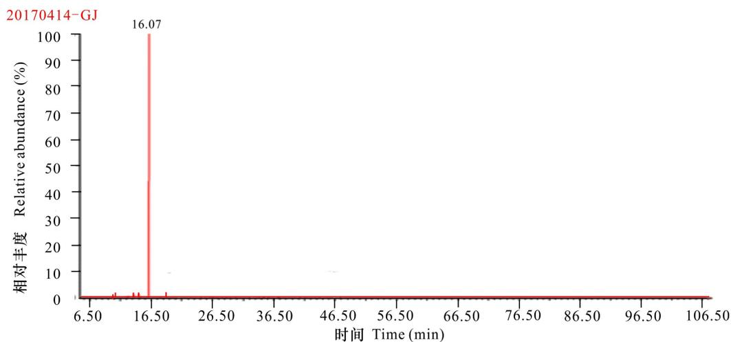
图 2 元江绿皮冰糖橙精油样品的总离子流色谱图
