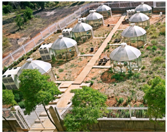
图 1 环境模拟控制实验系统封顶式生长室
